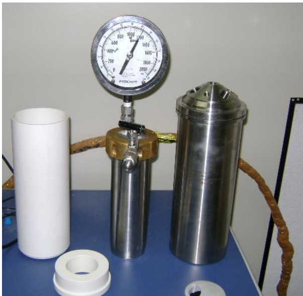
Figura 3. Partes do Sistema de Armazenamento. Da esquerda para a direita: Isolante Térmico, Cilindros Interno e Externo do Sistema Coaxial
