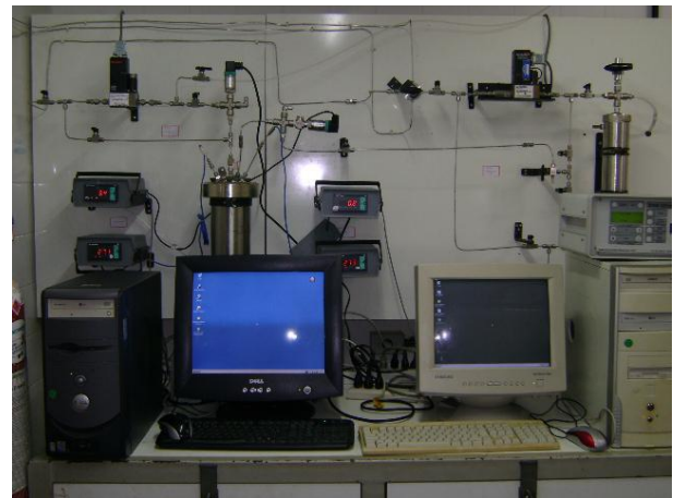
Figura 2. Unidade semi-piloto de armazenamento de gás natural por adsorção.
