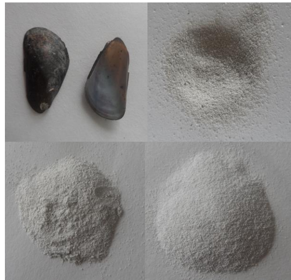
Figura 1. Figura 6 – Mariscos: (a) inteiro, (b) calcinado 60 mesh, (c) 100 mesh e (d) 140 mesh.
