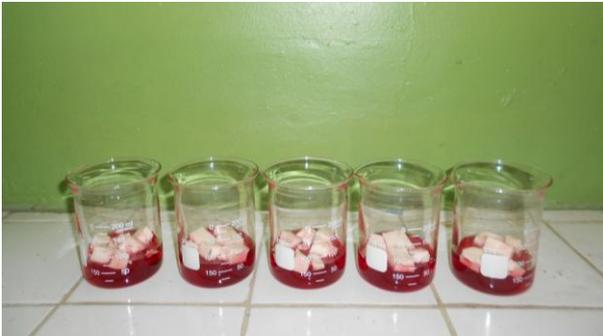
**Figura 1.** Sorção de óleo nos biocompósitos.
