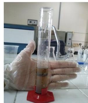
**Figura 4:** Análise volumétrica da quantidade de gasolina adsorvida.
