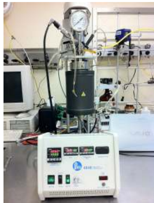
Figura 2. Reator do tipo “batch”
