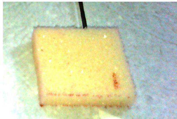
**Figura 1.** Corpo de prova para ensaio no teste de adsorção conforme norma ASTM F726-12.
